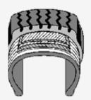
CORDÓN DE ACERO DE ALTA RESISTENCIA CON ESPESOR DE REVESTIMIENTO INTERIOR DE 4,0 MM
