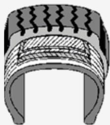
**CORDÓN DE ACERO DE ALTA RESISTENCIA CON ESPESOR DE REVESTIMIENTO INTERIOR DE 4,0 MM**
