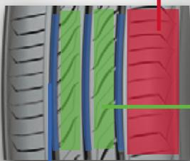
• Diseño de laminillas verticales anchas de tres piezas que proporcionan un mejor rendimiento de drenaje en caminos de lodo y agua, evitando el deslizamiento.
