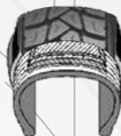
**CORDÓN DE ACERO REFORZADO DE ALTA RESISTENCIA CON ESPESOR DE REVESTIMIENTO INTERIOR DE 4,8 MM**
